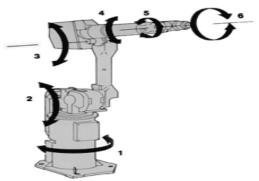
Fig: 2 Kinematic parameter of 6 DOF robot
